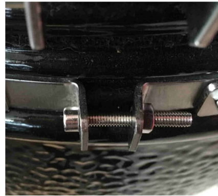
Spannschraube Spannring, Laschen zueinander geneigt
