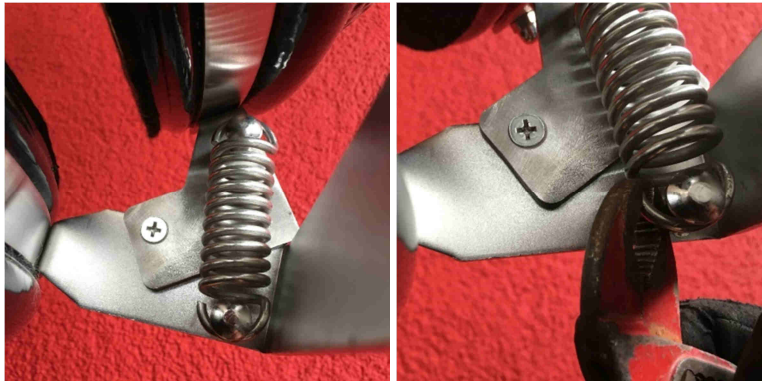
Feder rechte Scharnierseite Feder mit Zange aushängen
