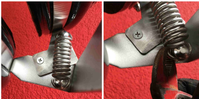
Feder rechte Scharnierseite Feder mit Zange aushängen
