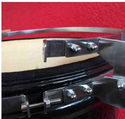
Lasche nach dem Ausrichten parallel zum Spannring
